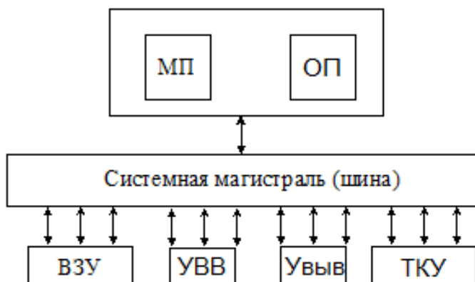
Рисунок 6 – Схема персонального компьютера
